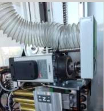
**Fresador com motor de alta frequência 18.000 rpm**
