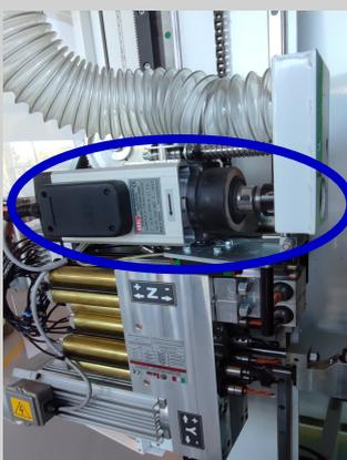
**Fresador de alta frecuencia 18.000rpm**
