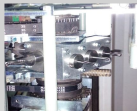
Taladro N°4. Broca de 35mm para Taladros frontales de Bisagra
