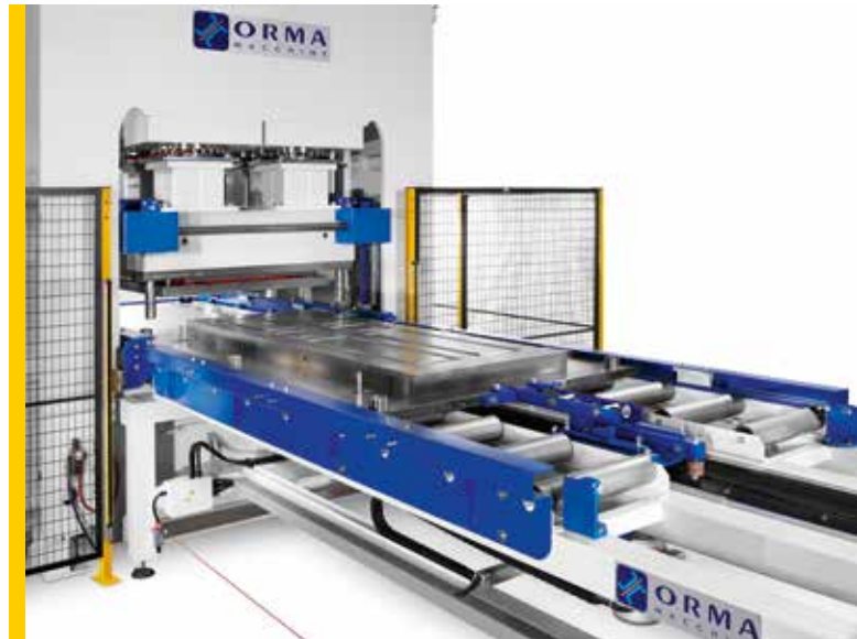
Dettaglio del sistema automatico di movimentazione dello stampo. Details of the automatic mould handling. Détail du système automatique de déplacement du moule. Detalle del sistema automático de movimentación del molde. Элемент автоматической системы перемещения пресс-формы.
