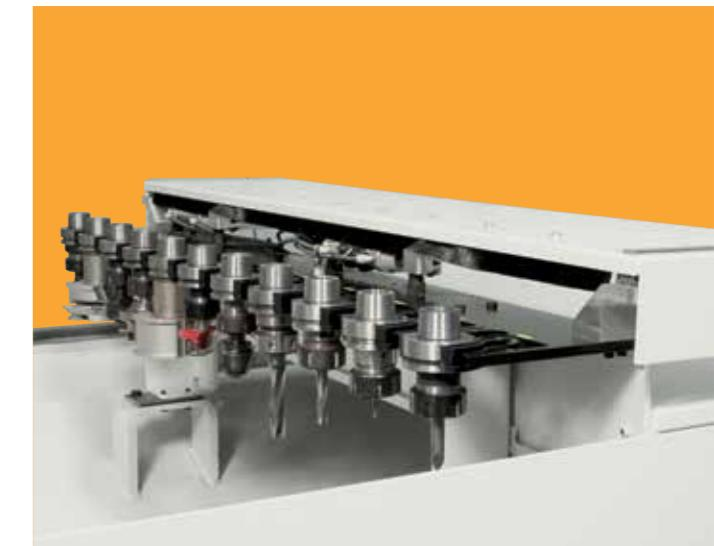
LINEAR T: magazzino a basamento per utensili di grandi dimensioni con copertura escludibile per la massima protezione degli utensili (opzionale).
