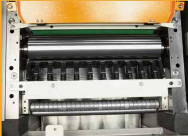
Gruppo pialla con martelletti anti-ritorno e pressatori in entrata sezionati, rullo di traino in acciaio con dentatura elicoidale in ingresso ed un rullo di traino ricoperto in gomma in uscita. I rulli sono facilmente intercambiabili. Rumorosità ridotta in fase di lavorazione.
