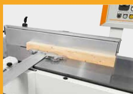
"TX MATIC" sicurezza massima: la protezione a sollevamento automatico "TX MATIC" adatta il proprio movimento al passaggio del legno garantendo la copertura costante dell'albero porta-colteggia ed un elevato livello di sicurezza.
