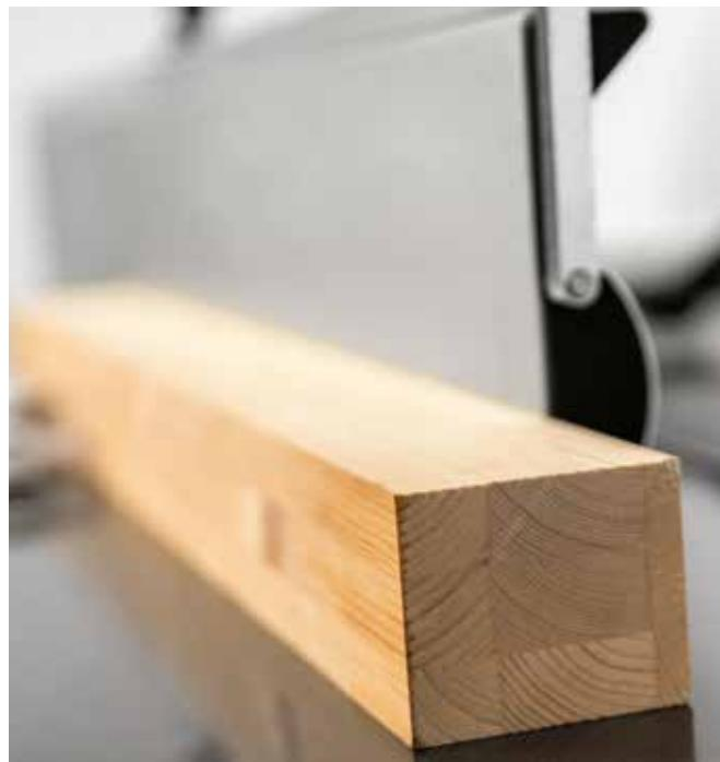
Guida a filo con ampia superficie di appoggio che consente di lavorare con precisione anche pezzi pesanti e di grandi dimensioni.
