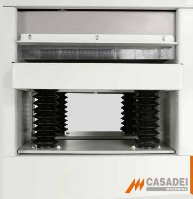
Sollevamento motorizzato del piano spessore a 2 velocità, con regolazione micrometrica e mediante 4 viti in acciaio protette da soffietti anti-polvere.
