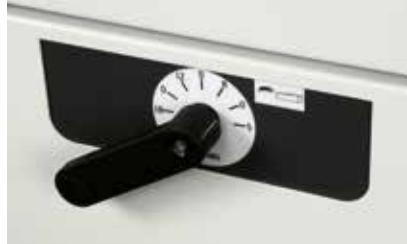
PS 630: Regolazione continua della velocità allo spessore tramite inverter da 4 a 20 m/min.
